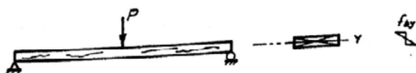
شکل ۶-۱۰b تیر از الوار بریده تحت خمش حول محور ضعیف
