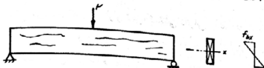
شکل ۶-۱۰a تیر از الوار اړه شده تحت لنگر حول محور قوی
